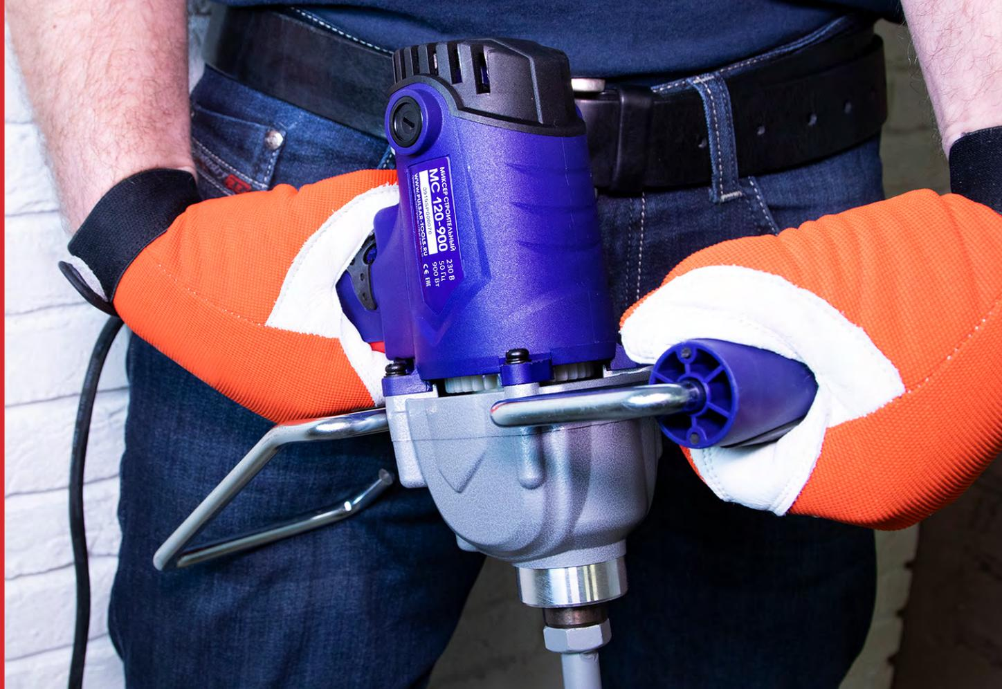
Строительный миксер предназначен для перемешивания краски, клея, герметика, штукатурки, строительных растворов, смесей и т.д. Мощный двигатель, металлический редуктор, электронное управление и эргономичные рукоятки – всё предусмотрено для работ на строительных площадках при высоких нагрузках.
